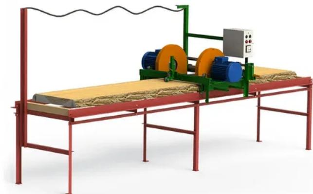
Станок двухпильный кромкообразной Алтай 011 с быстро устанавливаемыми размерами между пилами, предназначен для обрезки и раскряя необрезных досок и горбыля с целью получения чистообрезных пиломатериалов: обрезные доски, рейки, бруски, трехкантовый горбыль.
