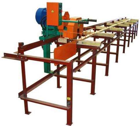
Станок однопильный кромкообрезной Алтай 007 с быстро устанавливаемыми размерными упорами заготовок, предназначен для обрезки и раскряя необрезных досок и горбыля с целью получения чистообрезных пиломатериалов: обрезные доски, рейки, бруски, трехкантовый горбыль.
