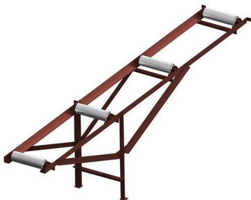
Роликовые столы, или рольганги Алтай, предназначены для ручной подачи древесных заготовок в зону их обработки деревообрабатывающим оборудованием. Рольганги используются в составе с деревообрабатывающими станками Алтай ТМ, Алтай ТЛ и другими марками лесообрабатывающего оборудования.
