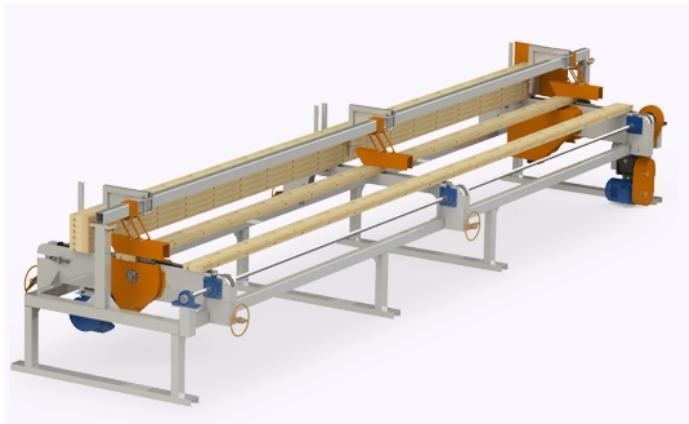
Торцовочные станки проходного типа предназначены для придания заготовкам(доскам) нужных размеров. Данные станки оснащены подвижными пильными блоками(от 2 до 6 по желанию заказчика).
