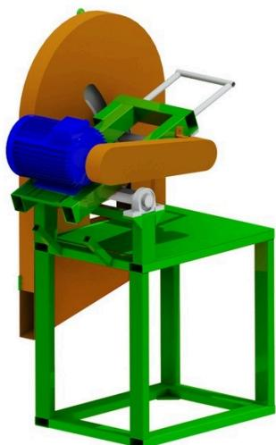
Станок торцовочный Алтай ТМ220 маятникового типа предназначен для поперечной резки досок, брусков и реек. Используется как вспомогательное оборудование в деревообрабатывающей и мебельной промышленности. Ход пилы - сверху вниз с помощью рукоятки подачи. Возврат пилы в исходное положение происходит без усилия на рукоятку подачи.
