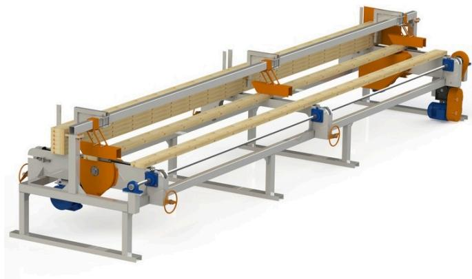
Станок торцовочный Алтай проходного типа предназначен для поперечной торцовки краёв досок, брусков и реек с делением их на требуемую длину. Используется как оборудование встраиваемое в линию в деревообрабатывающей и мебельной промышленности.
