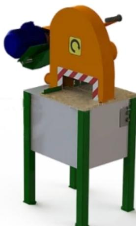
Станки торцовочные маятникового типа Алтай-ТМ, предназначены для обрезания заготовок (досок, брусков, горбыля) по длине и придания торцу четкой геометрии.
