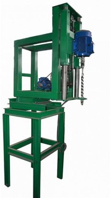
Станок сверлильный предназначен для сверления отверстий под шканты при строительстве деревянных домов. Станок встраивается в линию по профилированию бруса «Алтай-004».
