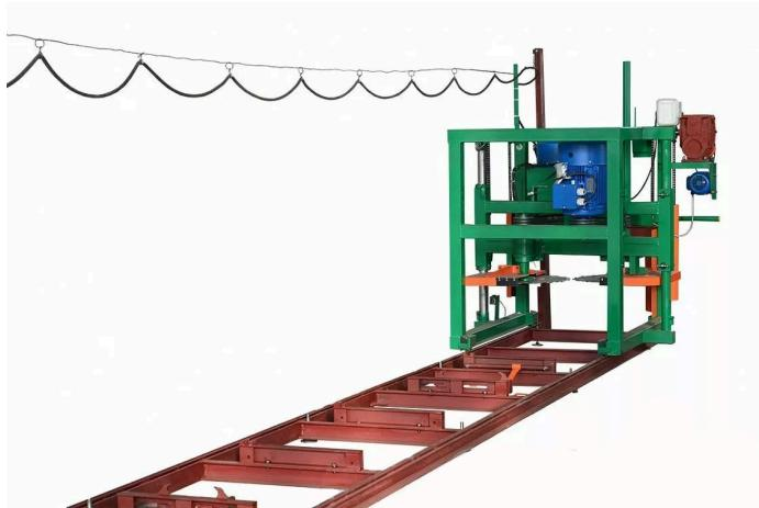
Двухдисковые горизонтальные циркулярные пилорамы Алтай ДПА 600-15 предназначены для распиловки круглых брёвен с целью получения обрезного и не обрезного пиломатериала: лафет, доски, рейки, бруски.
