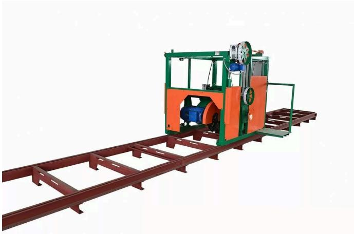
Станок дисковый углового пиления Алтай-ДПУ 560 предназначен для продольной распиловки круглых бревен диаметром до 800 мм и получения обрезного пиломатериала (доски, брус и т.д.)
