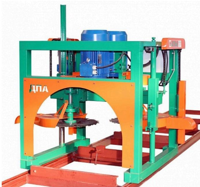
Пилорама дисковая Алтай (ДПА) горизонтальной модели предназначена для продольной распиловки пиловочника с целью получения пиломатериала в виде брусьев, брусков, обрезных и необрезных досок, а также шпона и шпалы.
