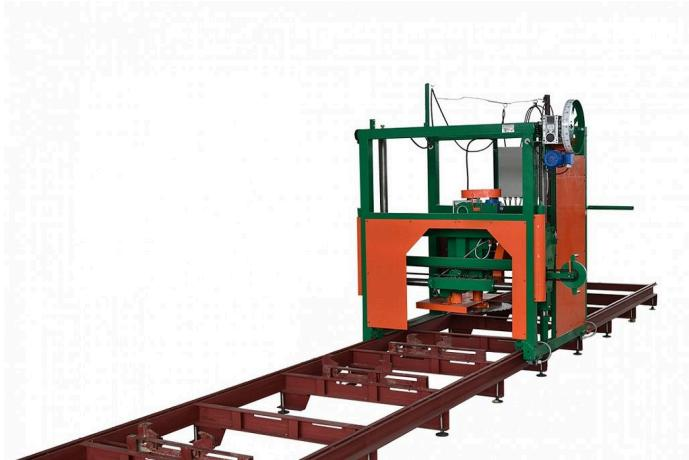
Дисковая пилорама поворотная "Алтай-ПДПУ560" предназначена для продольной распиловки бревен с целью получения бруса, доски, обрезных и необрезных пиломатериалов. Панель управления станком расположена на стенке шкафа управления.
