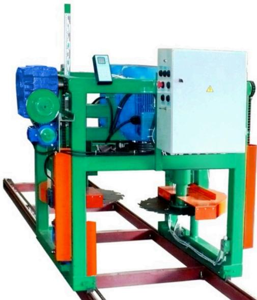
Дисковая пилорама Алтай ДПА560-15 предназначена для распиловки круглого леса на доску обрезную, необрезную, лафет, брус, бруск и так далее.
