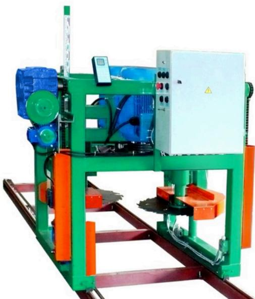
Дисковая пилорама Алтай ДПА 560 предназначена для распиловки круглого леса на доску обрезную, необрезную, лафет, брус, бруск и так далее.
