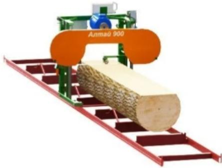
Горизонтальная стационарная ленточная пилорама «Алтай-1400» предназначена для производства обрезных и необрезных досок, бруса, шпала, шпона из круглых бревен и других древесных заготовок.
