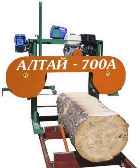
Ленточная пилорама Алтай 700А является пилорамой с приводом от бензинового двигателя Honda мощностью 20 л.с. и диаметром шкивов 520 мм, предназначеннной для продольной распиловки круглого леса диаметром до 700 мм, на доски, шпалы, брус, шпон и другие пиломатериалы.
