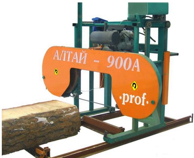
Ленточная пилорама Алтай 900А Prof является пилорамой с приводом от бензинового двигателя Lifan мощностью 24 л.с. и диаметром шкивов 600 мм, предназначенной для продольной распиловки круглого леса диаметром до 900 мм, на доски, шпалы, брус, шпон и другие пиломатериалы.
