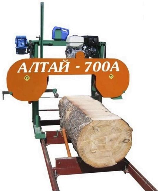
Ленточная пилорама Алтай 700А является пилорамой с приводом от бензинового двигателя Lifan мощностью 24 л.с. и диаметром шкивов 520 мм, предназначенной для продольной распиловки круглого леса диаметром до 700 мм, на доски, шпалы, брус, шпон и другие пиломатериалы.
