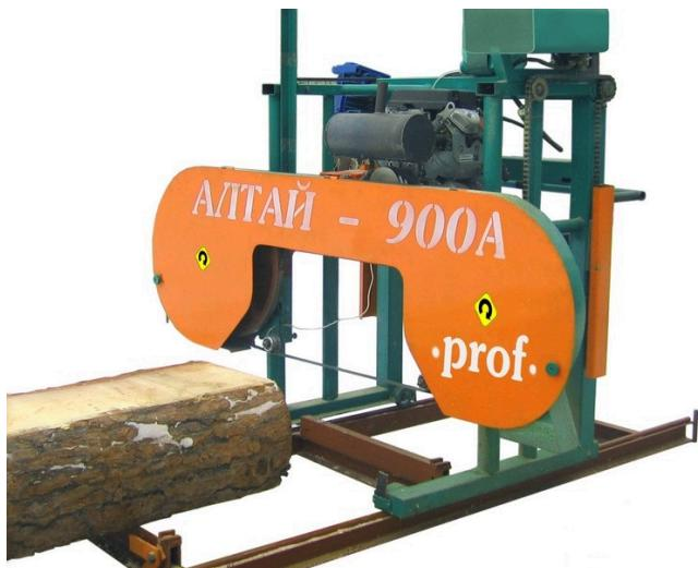
Ленточная пилорама Алтай 900А Prof является пилорамой с приводом от бензинового двигателя Honda мощностью 20 л.с. и диаметром шкивов 600 мм, предназначеннной для продольной распиловки круглого леса диаметром до 900 мм, на доски, шпалы, брус, шпон и другие пиломатериалы.
