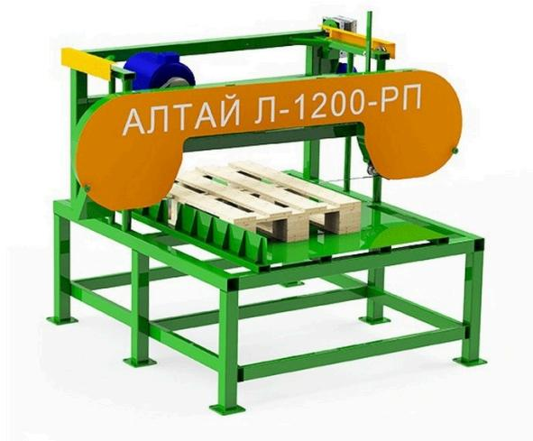
Станок предназначен для разбора поддонов перед их последующим ремонтом.
