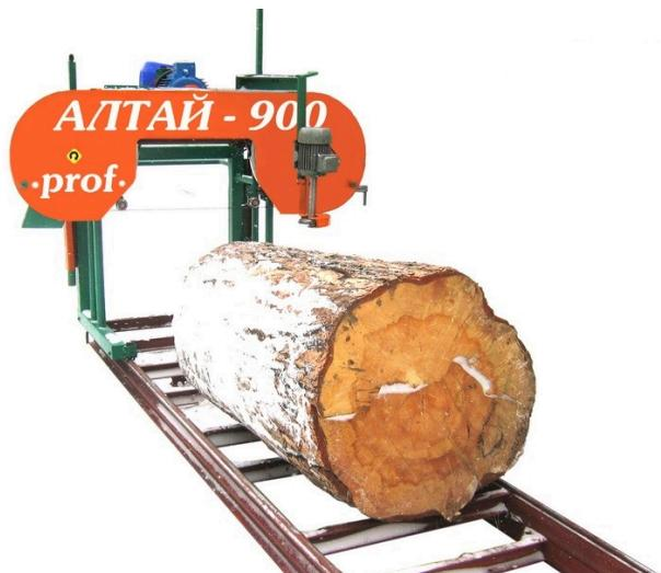
«Алтай 900» способен работать на протяжении всего дня без каких-либо повреждений или перегрева как двигателя, так и полосы пилы. Это объясняется тем, что для охлаждения ленты используется капельная система, которая попадая на ленту, охлаждает её, тем самым не позволяя ей перегреваться и деформироваться или разрушаться.
