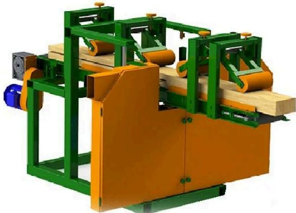
Станок ленточнопильный делительный «Алтай-СДМ-1» предназначен для продольной распиловки (роспуска по длине) бруса, досок, горбыля.
