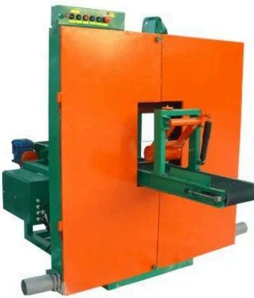
Станок ленточнопильный делительный для распиловки лафета и бруса «Алтай-СД2» предназначен для продольной распиловки (роспуска по длине) бруса, досок, горбыля.
