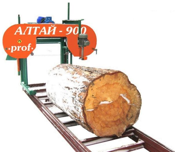
Ленточная пилорама Алтай 900 Prof является пилорамой с электроприводом от электродвигателя мощностью 11 кВт и диаметром шкивов 600 мм, предназначеннной для продольной распиловки круглого леса диаметром до 900 мм, на доски, шпалы, брусы, шпон и другие пиломатериалы.
