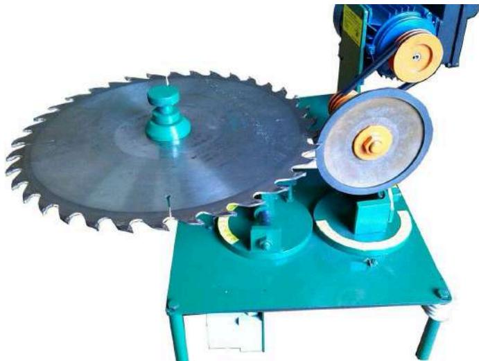
Заточной станок «Алтай-3650», предназначен для заточки дисковых пил с твердосплавными пластинами по передней и задней поверхностям.
