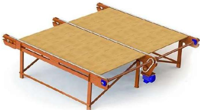
Транспортеры поперечные 3-х цепные предназначены для поперечного перемещения пиломатериалов к месту их переработки, сортировки, упаковки.
