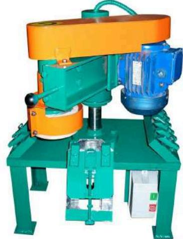
Заточное устройство «Алтай-сзн-Р1» предназначено для заточки ножей фрез.
