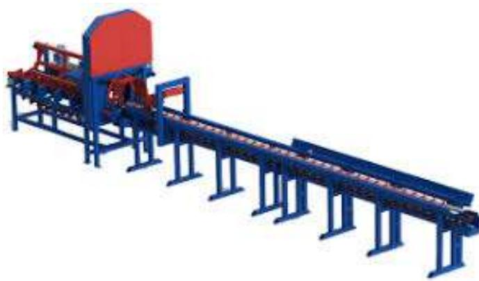
Оборудование предназначено для приема бревен, их поперечного распила дисковой пилой на заданную длину и передачу на последующую обработку.
