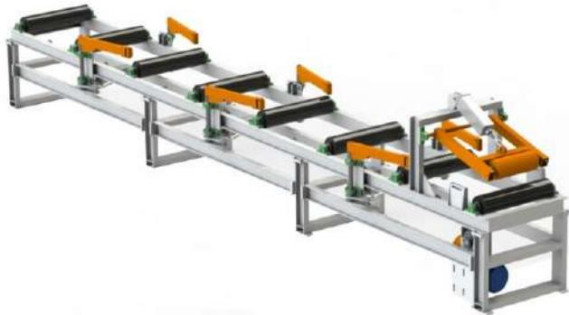
Центрователь предназначен для автоматической центровки и подачи лафетов, брусьев, досок в многопильный или обрезной станок. Материал, перемещающийся по рольгангу, в нужный момент выставляется по оси рольганга центрирующими рычагами. Далее брус прижимается к зубчатым роликам и вводится в механизм подачи станка. Центрователь позволяет исключить наличие обслуживающего персонала на операции подачи заготовок (минимум одного рабочего), увеличить скорость и повысить точность подачи материала.
