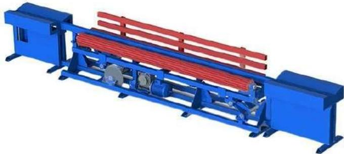
Кантователи бревен для бревнопильных станков предназначены для увеличения выхода готовой продукции за счет рационального позиционирования бревна перед распиловкой.
