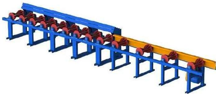
Оборудование предназначено для перемещения круглого леса к месту его распиловки либо сортировки.
