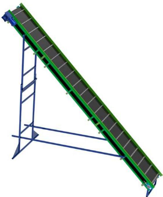
Транспортер ленточно-скребковый мод. ТЛС-400 - предназначен для перемещения материала в горизонтальном направлении и под углом до 45 градусов. Может быть использован как отдельно, так и в производственных цепочках линии оборудования. При производстве применяются прочные, надежные и износостойкие материалы, что значительно увеличивает срок службы оборудования.
