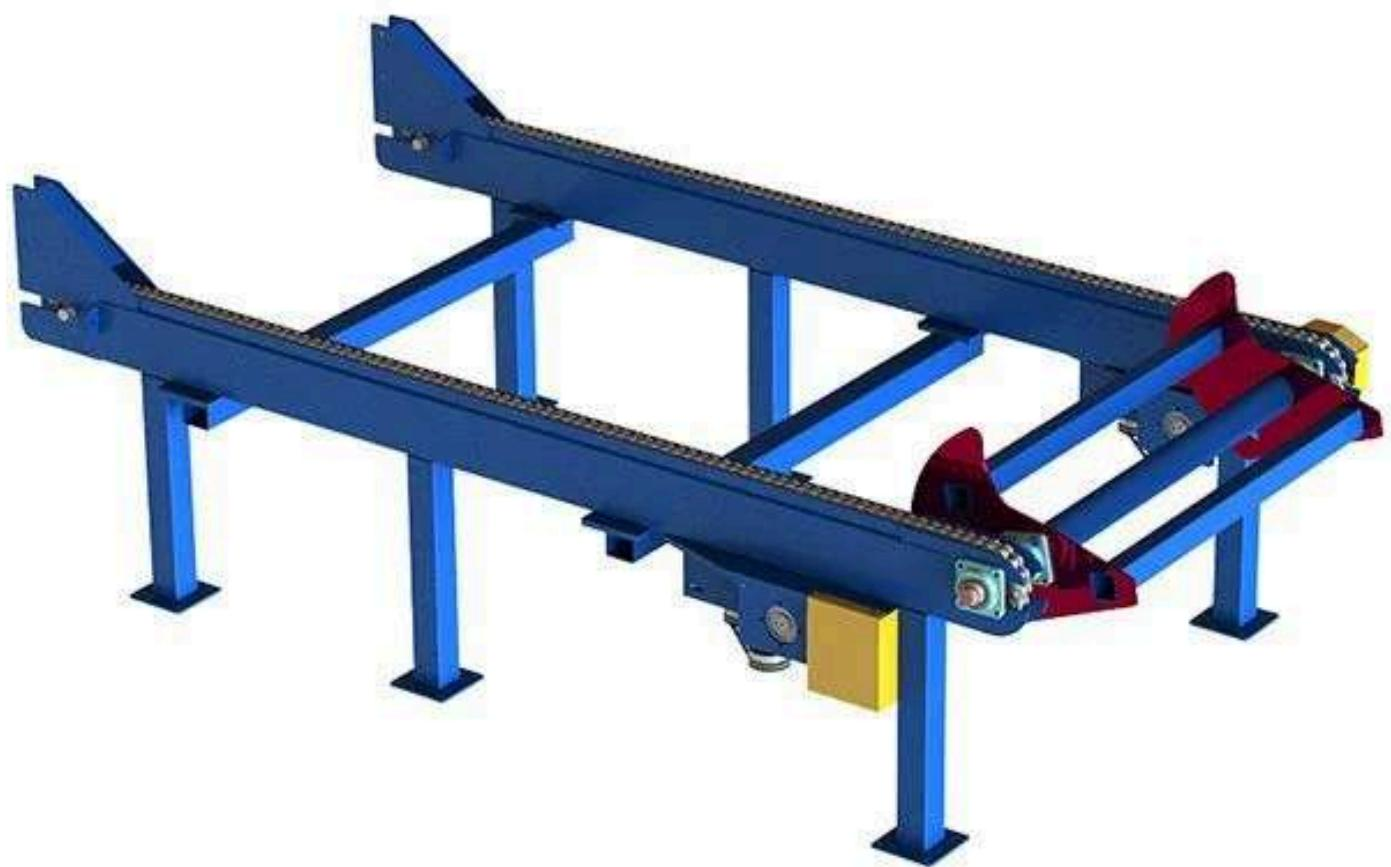
Устройство поштучной выдачи бревен предназначено для транспортировки и выдачи круглых бревен на бревнопильные станки.
