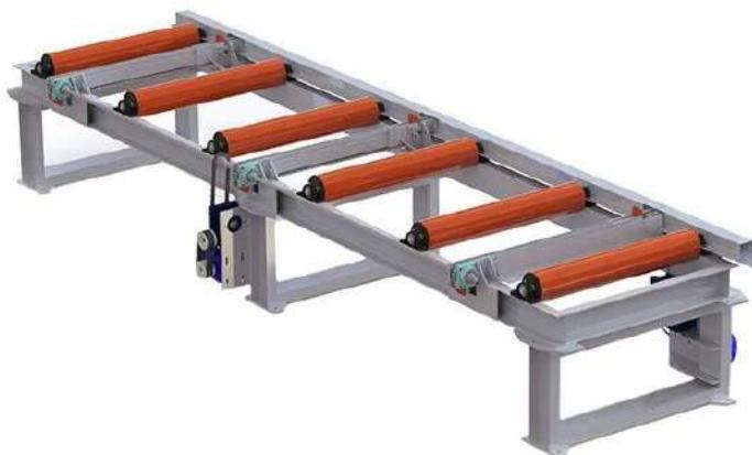
Приводные рольганги сбрасывающие предназначены для продольного перемещения пиломатериалов с их последующим сбрасыванием к месту сортировки - упаковки либо дальнейшей переработки.
