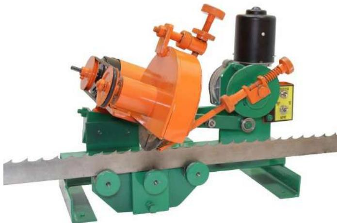
Заточные приспособление «Алтай-з22» ленточных пил. «Алтай-з22» автоматически затачивает зубья пильной ленты под определенный профиль каждого зуба.
