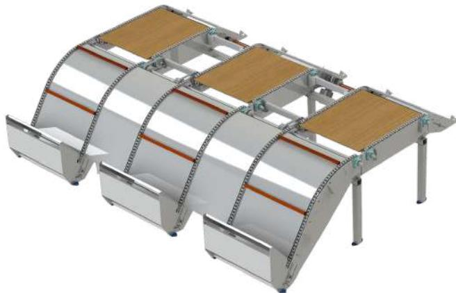
Горка - разобщитель бревен предназначена для расформирования пачек обрезного пиломатериала и его поштучного перемещения для последующей обработки.
