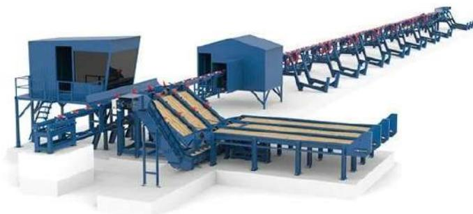
Линия сортировки бревен предназначена для автоматической сортировки бревен по нескольким критериям (порода, длина, кривизна, диаметр, и т.п.) и распределения их в индивидуальные накопительные карманы.
